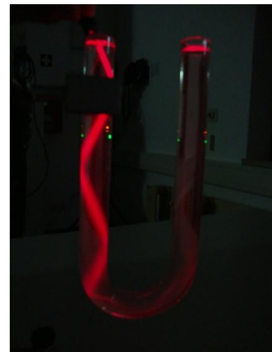
Abbildung 58: Totalreflexion im U-Rohr
