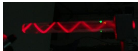
Abbildung 57: Totalreflexion im Reagenzglas
