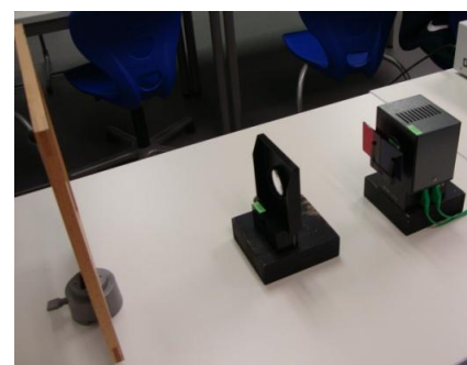
Abbildung 87: Versuchsaufbau zur chromatischen Aberration
