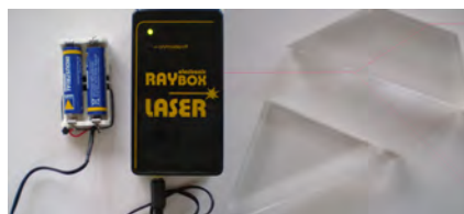
Abbildung 38: Brechung mit dem Tischlaser
