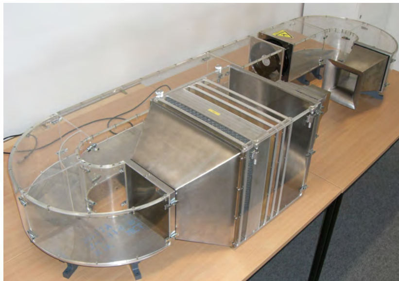
Abbildung 8.1.: Der modulare Schülerwindkanal der Universität Göttingen [LAU07]
