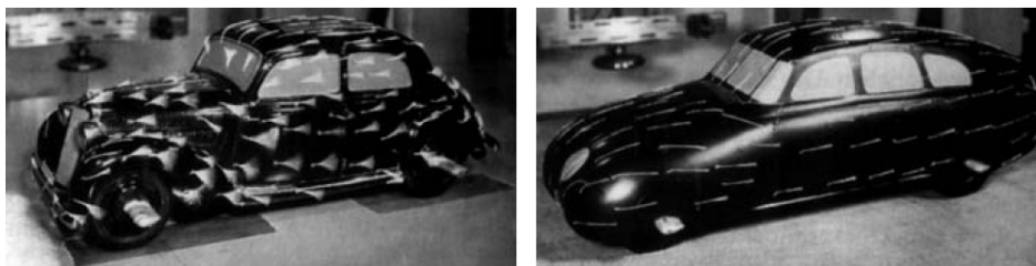
Abbildung 8.11.: Visualisierung der Strömung durch Wollfäden [NIT06, S.155]
