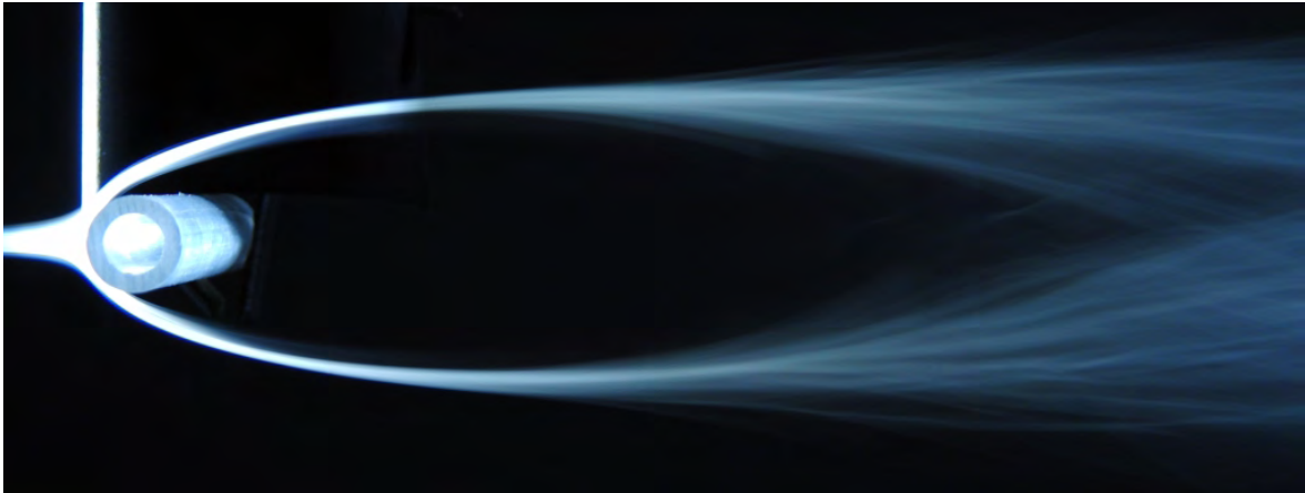
Abbildung 8.13.: Strömung um einen Zylinder mit schwarzem Hintergrund und LED-Hintergrundbeleuchtung bei langer Belichtungszeit
