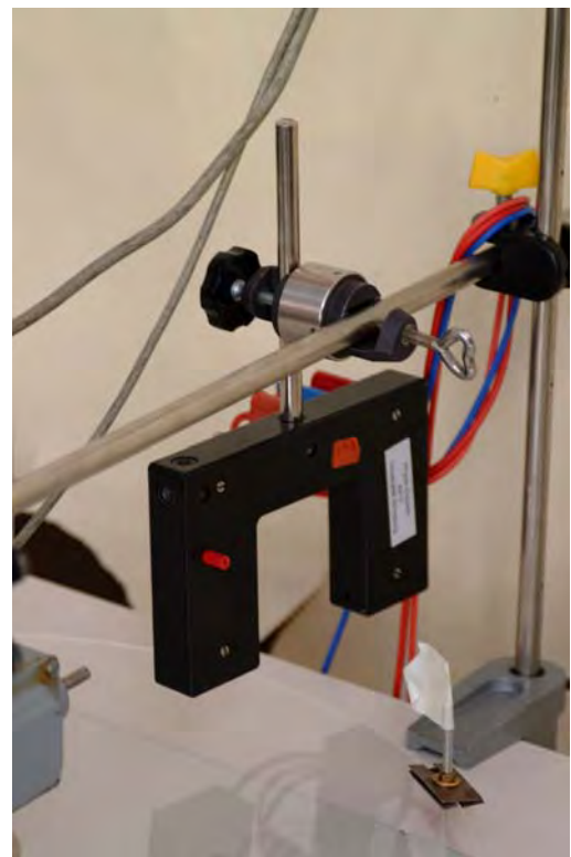
Abb. 3.13: Lichtschranke und Fähnchen zum Auslösen der Startvorrichtung
