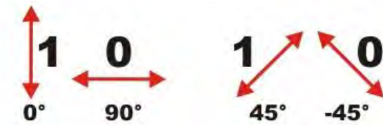
Abbildung 3.6: Basis + (links) und Basis x (rechts); die Pfeile stellen die Polarisationsrichtung dar [IQU9]
