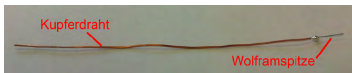
Abbildung 3.45: an den Kupferträger gelötete Wolframspitze
