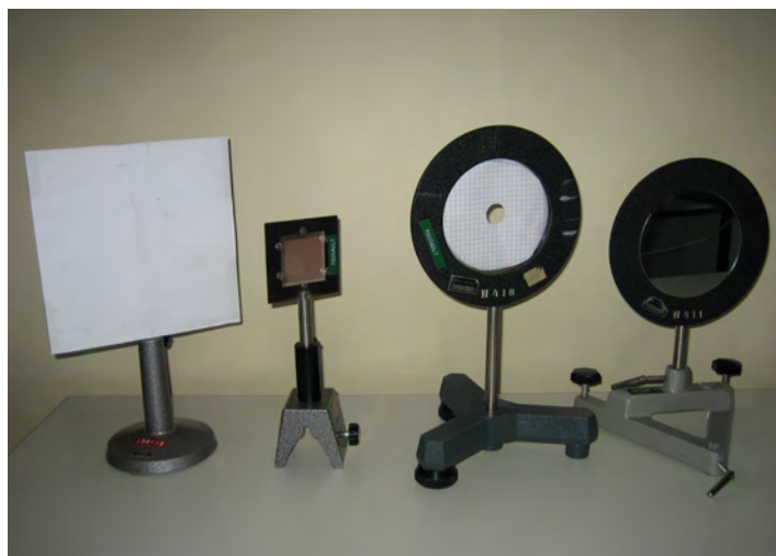
(c) Schirm, Strahlteiler, Sammellinse und Planspiegel (von links)
