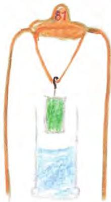
Über die Auflageplatte einer Waage führen wir eine Schnur an die wir verschiedene Dinge hängen. Wir messen das Gewicht in der Luft und im Wasser. Zugleich lesen wir am Messbecherglas die Zunahme des Wasserstandes ab, und haben damit das Volumen (die Raumnahme) im Wasser des Körpers bestimmt.
