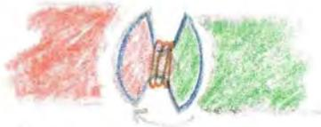
Die Pole des Ankers und die Pole des Hufeisenmagneten stoßen sich ab. Damit der Anker sich bewegt muss man ihn andrehen.
