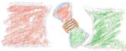
Der Polwender polt den Anker um, sodass der Anker sich weiter drehen kann. Durch die bereits vorhandene Drehbewegung muss der Anker nicht wieder angelehrt werden er hat noch Schwung. \*
