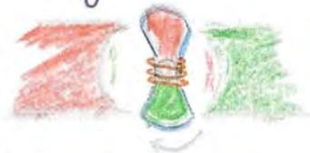
Die ungleichnamigen Pole ziehen sich an. Es kommt dadurch zu einer Drehung, die keine Hilfe von außen benötigt.
