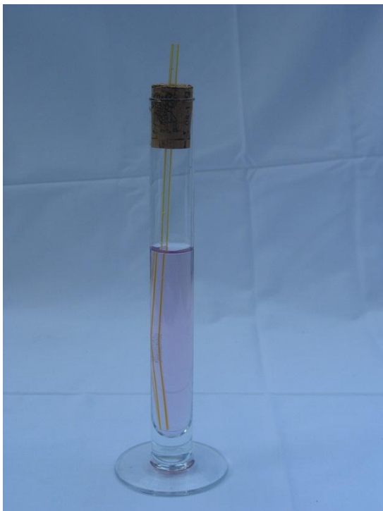
Abb. 27: Thermometer aus Alltagsgegenständen
