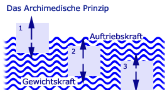
Abb. 7: Das Archimedische Prinzip
