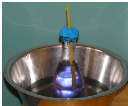
Abb.10: Das Flaschenthermometer
