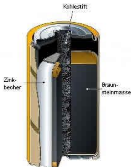
Abb.5.3: Batterie im Querschnitt
