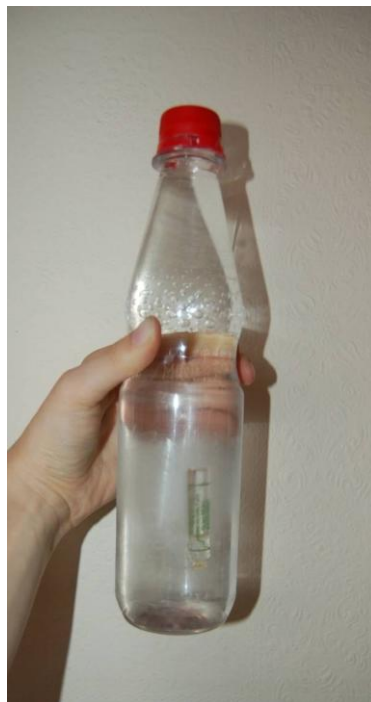
Abb. 3.10: Versuch „Kartesischer Taucher“
