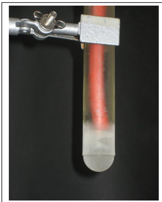
Abb. 5.38: Wärmepumpe – Versuch 4 – vereistes Glas
