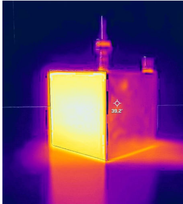
Abbildung 5.13 | Das Wärmebild zeigt die Abstrahlung der schwarzen und verspiegelten Seite des Leslie-Würfels. Die gemessene Oberflächentemperatur von 39,2 °C stimmt nicht mit der tatsächlichen überein, da der eingestellte Emissionsgrad für den Infrarot-Sensor nicht für die polierte Seite geeignet ist.
