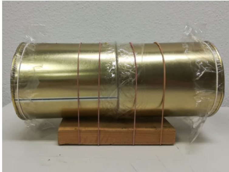
Abbildung 5.4 | Zwei Metalldosen, die luftdicht zusammengefügt wurden. In der Doppeldose befindet sich ein CO 2 -Sensor sowie ein kleiner Ventilator zur Luftzirkulation. Sie wurde ebenfalls mit Frischhaltefolie beidseitig abgedichtet.
