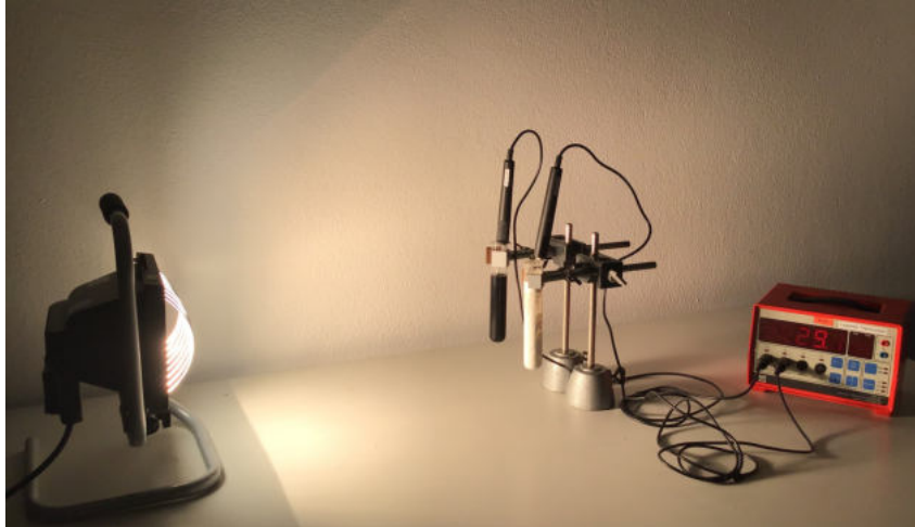
Abbildung 5.15 | Versuchsaufbau zum Rückstrahlvermögen. Ein schwarzes und ein weiß lackiertes Reagenzglas, das jeweils mit Wasser befüllt ist, werden von einem Baustrahler angestrahlt. Die Temperatur wird dabei digital über zwei Fühler gemessen.
