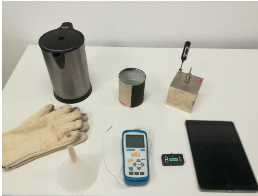
Abbildung 5.12 | Materialien zum Leslie-Würfel-Versuch. Zu sehen ist auch eine selbst präparierte Dose, die ebenfalls für das Experiment verwendet werden kann.
