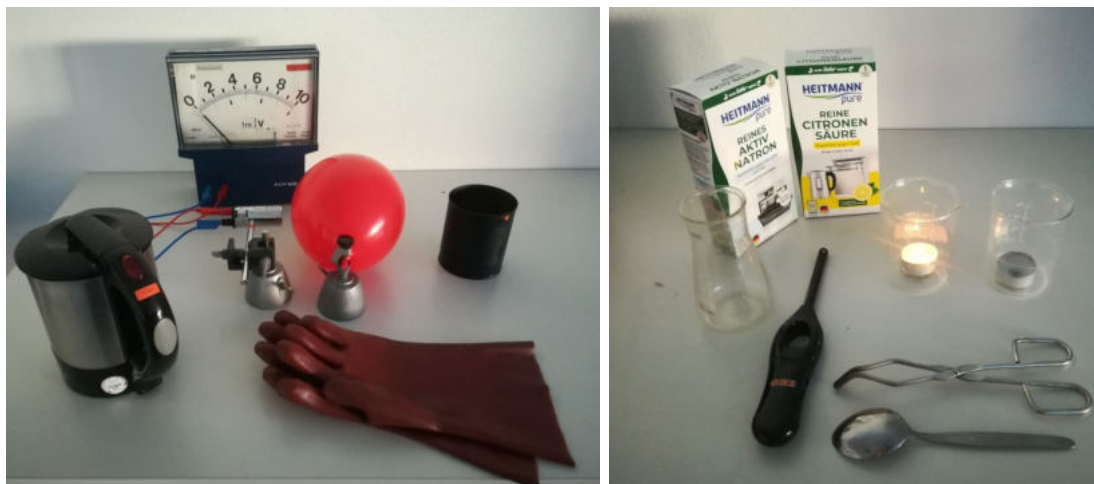
Abbildung 5.18 | Links: Aufbau des Experiments zur Bestimmung der IR-Durchlässigkeit von Kohlenstoffdioxid. Rechts: Sauerstoff-Nachweis in zwei Bechergläsern mit selbst produziertem \text{CO}_2 .
