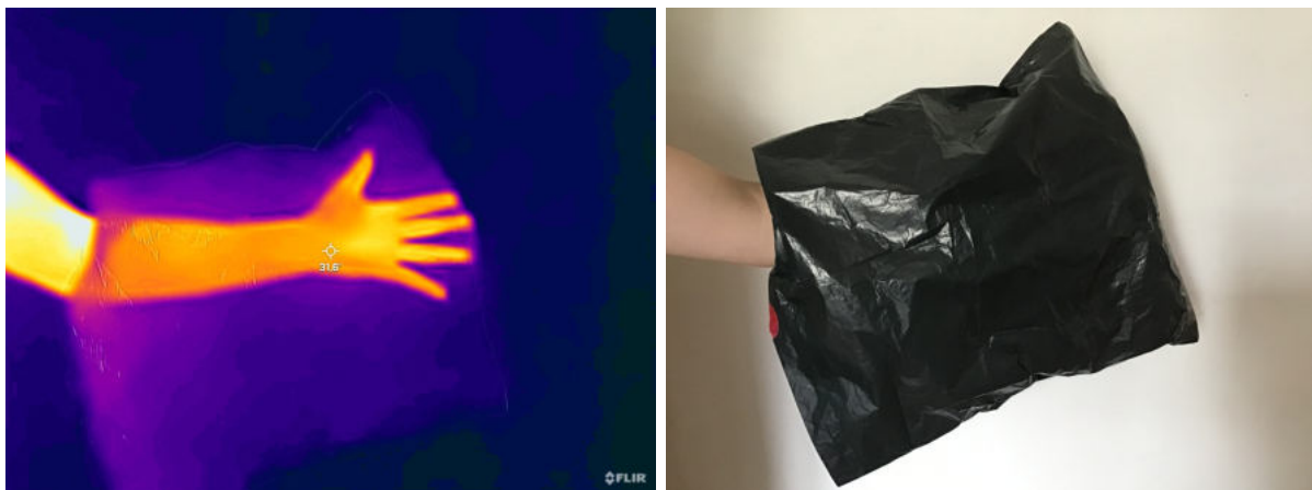
Abbildung 5.10 | Aufnahme eines Unterarms in einer schwarzen Mülltüte mit und ohne Wärmebildkamera.
