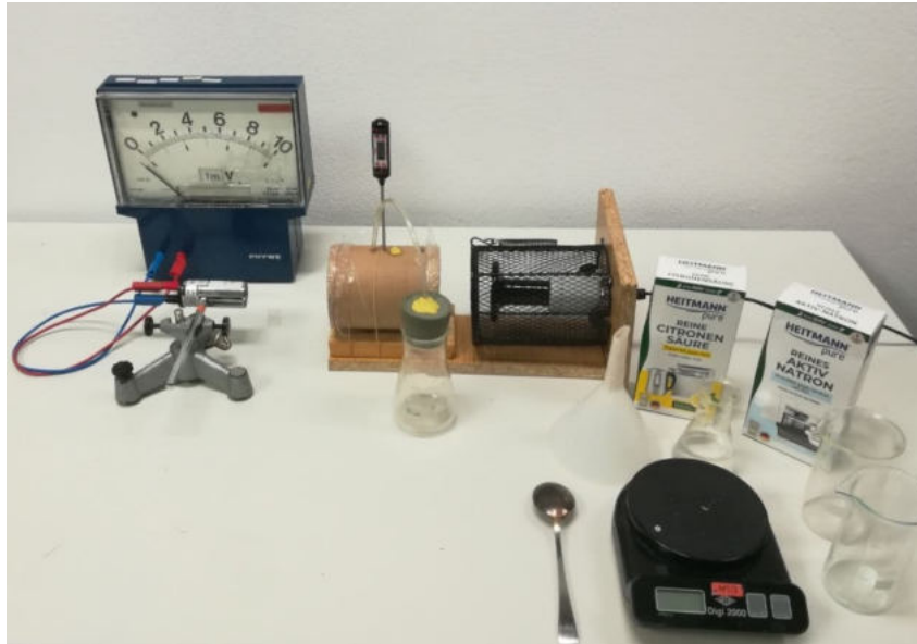
Abbildung 5.1 | Aufbau des Modellexperiments zum Treibhauseffekt. Die Luft in der abgedichteten Pappdose wird von einem Wärmestrahler aufgewärmt und die Temperatur mithilfe eines Thermometers gemessen. Die Thermosäule, die hinter der Dose positioniert wird, misst die eingehende Wärmestrahlung. Die Materialien zur Herstellung von Kohlenstoffdioxid sind auf der rechten Seite zu sehen.
