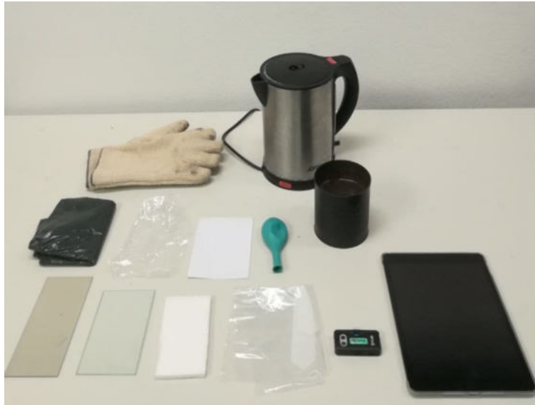
Abbildung 5.8 | Versuchsaufbau zum Grundlagenversuch zur Wärmestrahlung. Zu sehen sind neben der Wärmebildkamera und dem iPad die verschiedenen Materialien, die auf IR-Durchlässigkeit zu überprüfen sind sowie eine schwarze Metalldose, die als Wärmequelle dient.
