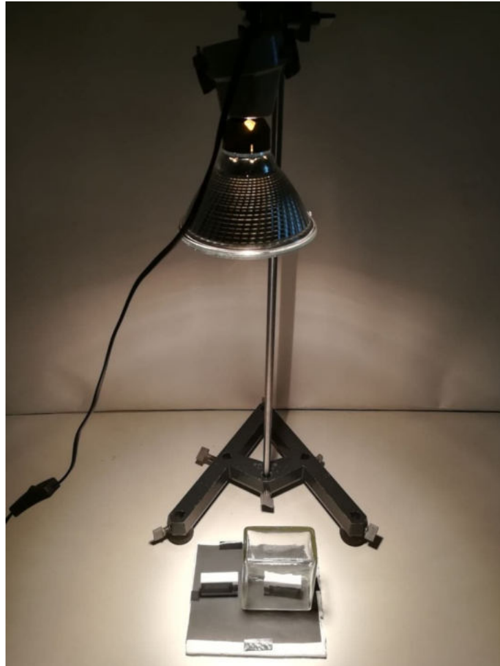
Abbildung 5.14 | Versuchsaufbau zum natürlichen Treibhauseffekt. Die schwarze Pappe wurde auf einem Styropor-Untergrund befestigt und wird in genügend großem Abstand gleichmäßig vom Halogenstrahler beleuchtet.
