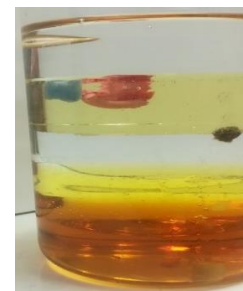
Abbildung 2.2 Ausschnitt des Becherglases mit ingesunkenen Gegenständen: Wachs (Blau), Gummiballon (rot), Karton (schwarz) und Kreide
