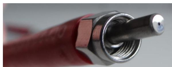
Abb. 21: Die mitgelieferten Lichtleiter mit 40 bzw. 400 µm Fenster
