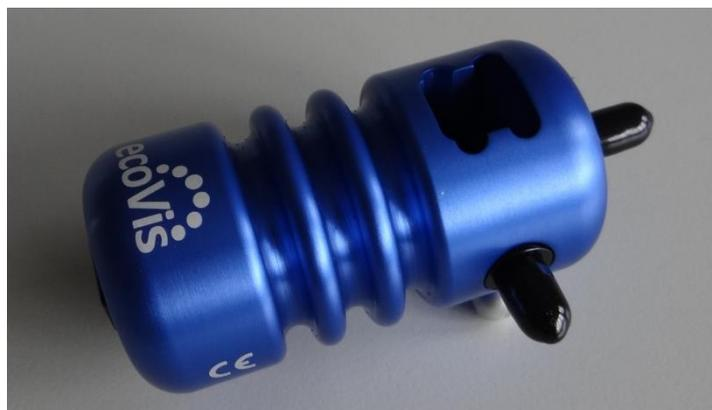
Abb. 20: Externen Küvettenhalter der Firma Phywe
