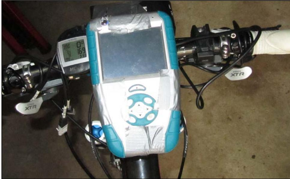
**Abbildung 16: Befestigung des Datenlogger am Vorbau**
