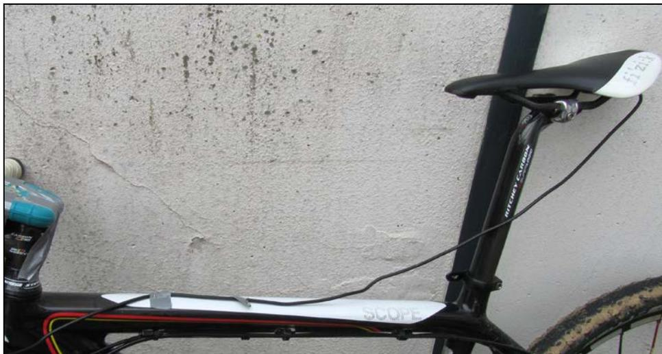
**Abbildung 17: Montage des Beschleunigungssensors**
