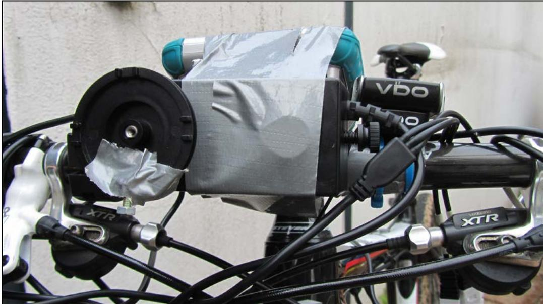
**Abbildung 32: Montage des Drehwinkelsensors**
