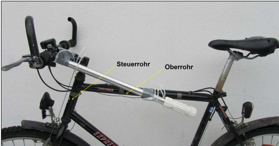
Abbildung 29: Versuchsrad mit starrem Lenker
