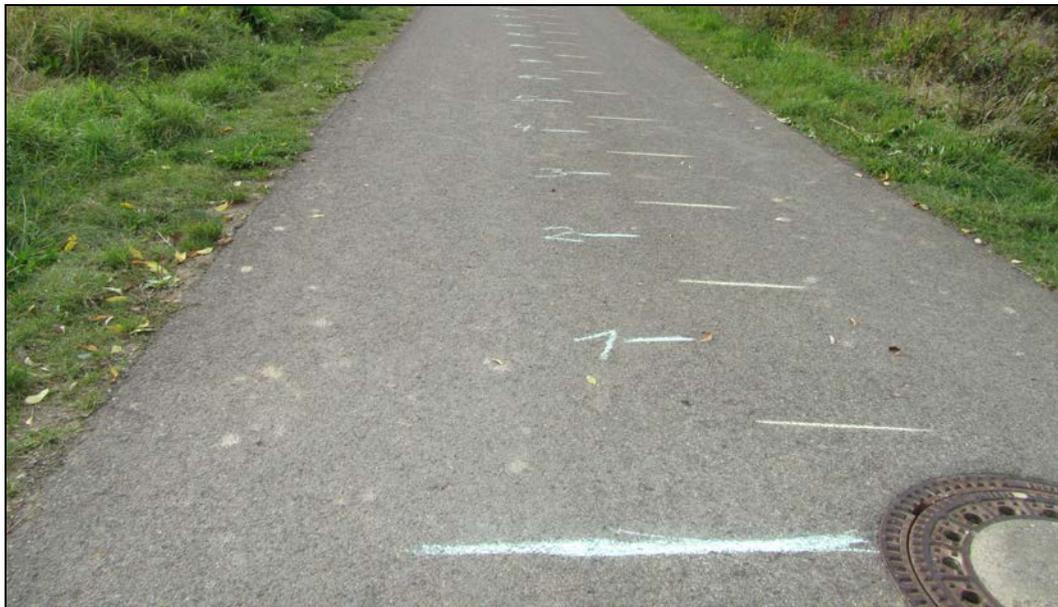
Abbildung 13: Messskala für Bremsversuche
