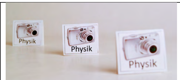
Abb. 116: Schärfentiefe bei mittlerer Blendenzahl ( B_L = 5.6 )
