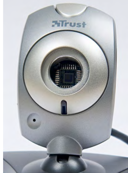
Abb. 2: Webcam mit abgeschraubtem Objektiv
