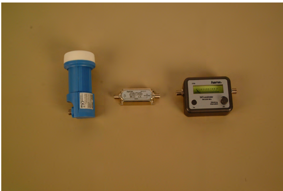
Abbildung 25: von links nach rechts: LNB, Sat-Verstärker, Sat-Empfänger
