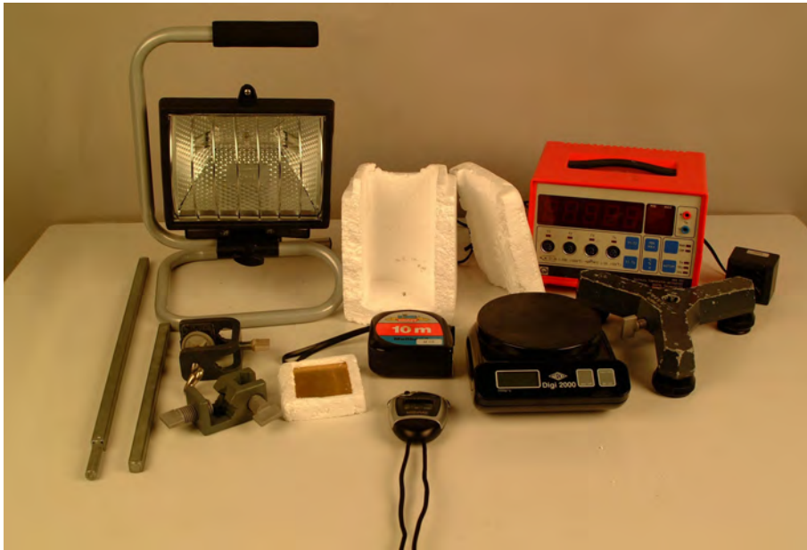
Abbildung 52: Materialien zur Bestimmung der Solarkonstanten mit Hilfe einer Messingplatte
