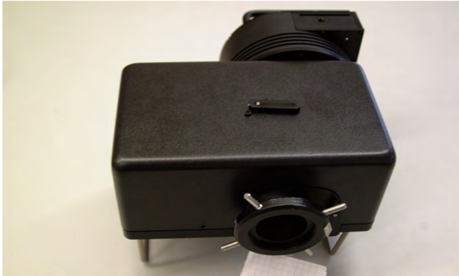
Abbildung 33: CCD-Kamera mit Gitterspektroskop
