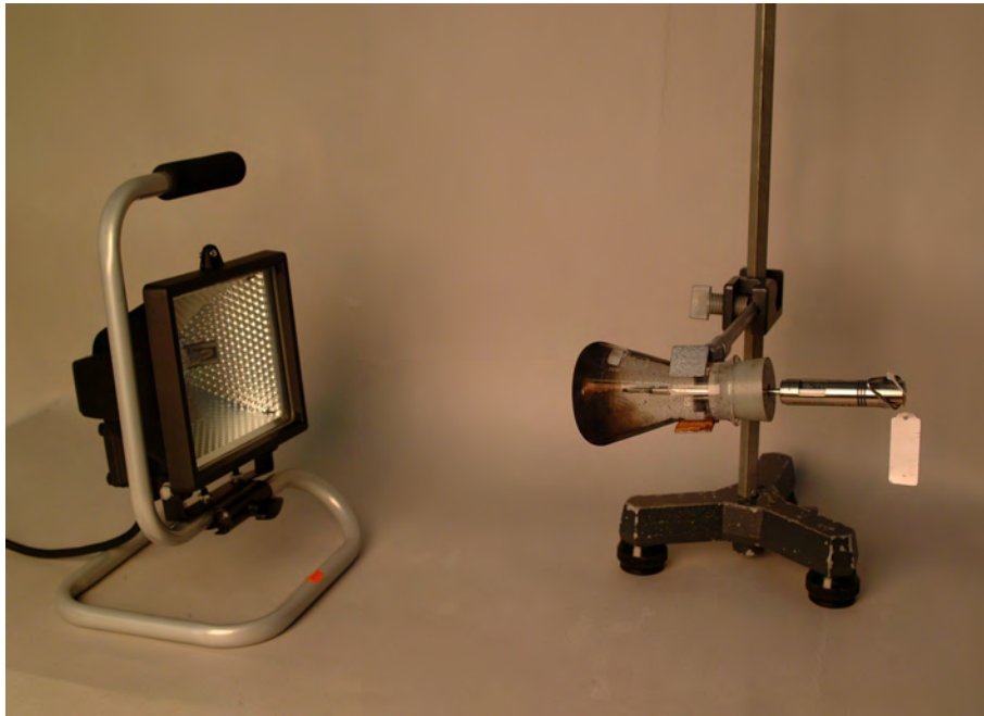
Abbildung 53: Versuchsaufbau Solarkonstantenbestimmung mit Hilfe eines Erlenmeyerkolbens
