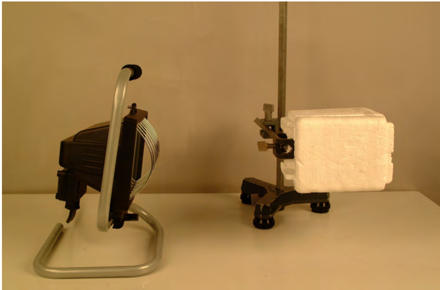
Abbildung 54: Versuchsaufbau zur Solarkonstantenbestimmung mit Hilfe einer Messingplatte
