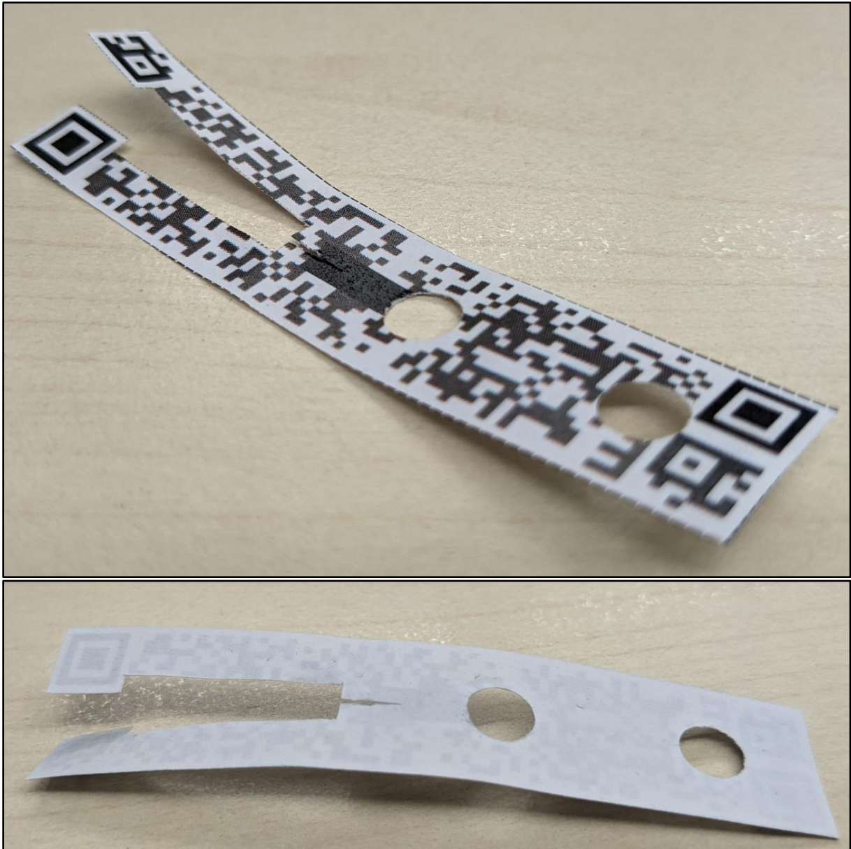
Abbildung 3: Bei den Markern für die Widerstände können die Löcher gut mit einem Locher gemacht werden. Die Marker sollten für einen leichteren Einbau beim Rechteck eingeschnitten werden, wie auf dem unteren Bild erkennbar ist. Die Marker sind spezifisch für die Widerstände! Beim Aufkleben nicht verwechseln.
