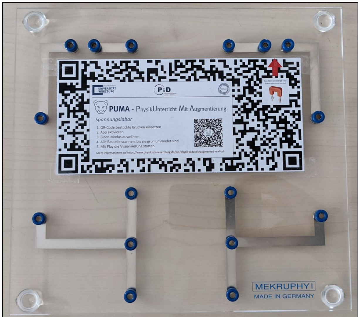
Abbildung 5: Das Endresultat muss so aussehen. Das Target dabei mittig zwischen den senkrechten Leitern aufkleben und etwa 6 mm vom oberen Leiter entfernt.
