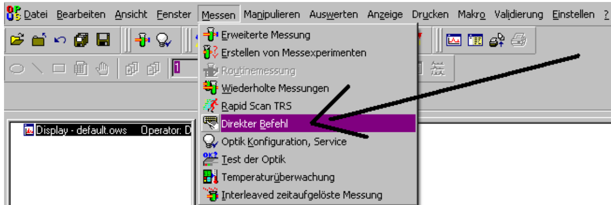
Abb.4: Über den Menüpunkt Direkter Befehl lässt sich einfach zwischen Reflexions- und Transmissionsmessung umschalten.
