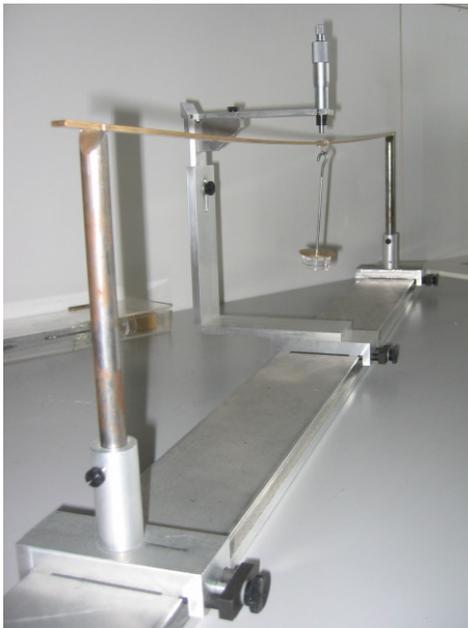
*Man lege den jeweiligen Stab so auf die Schneiden (Abstand  $l$ ), dass die Stabenden nur sehr wenig überstehen und belaste sie über einen Träger in der Mitte mit Zusatzmassen  $m_i$ .*
