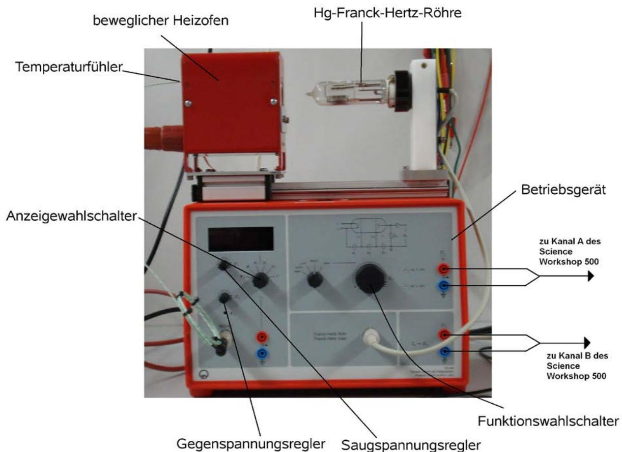
Abbildung 6: Versuchsaufbau zur Aufnahme einer Franck-Hertz-Kurve an Quecksilber
