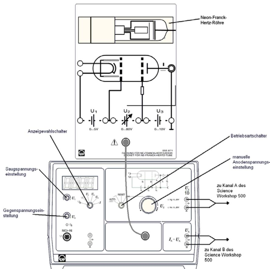
Abbildung 2: Versuchsaufbau zur Aufnahme einer Franck-Hertz-Kurve von Neon
