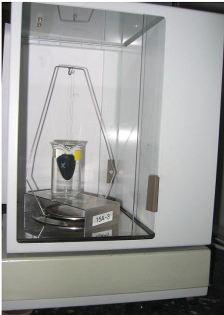
*Als Flüssigkeit nehme man Wasser. Zunächst wird die Dichte von Wasser mit einem geeichten Verdrängungskörper aus Glas (**Duran 50**) bestimmt, dessen Volumen  $10.000 \text{ cm}^3$  ist. Vor Beginn der Messreihe wird zunächst  $m_K^L$  des trockenen Verdrängungskörpers bestimmt.*
