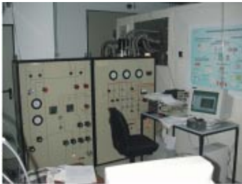
Arbeitsplatz für Tieftemperaturmessungen: links Meßcomputer und Temperaturkontrolle, rechts im Boden eingelassener Kryostat und Meßgeräte im Faraday-Käfig.
