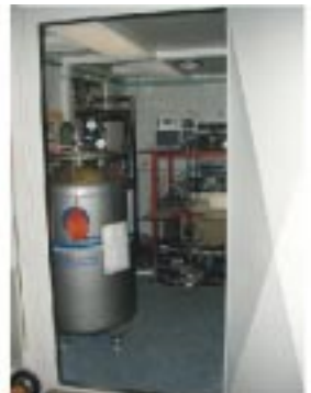
Arbeitsplatz für Tieftemperaturmessungen: links Meßcomputer und Temperaturkontrolle, rechts im Boden eingelassener Kryostat und Meßgeräte im Faraday-Käfig.
