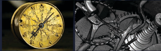
Mikro-Computertomogramm einer Uhr aus dem frühen 16. Jhdt. Peter Henlein zugeschrieben.
