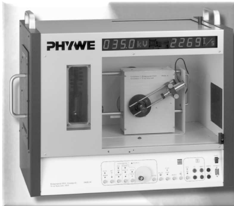
Abbildung 1: Versuchseinheit mit Röntgenröhre (Einschub von links, Anode sichtbar durch Fenster auf Frontseite) und Goniometer in Experimentierbereich. Auf der Frontseite befindet sich oben die LED-Anzeige und unten die Bedienelemente.
