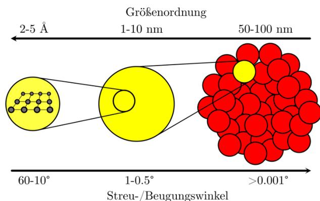
Röntgenstreuung und -beugung ist eine zerstörungsfreie Messmethode mit deren Hilfe Materialien und Proben auf Größenskalen von einigen Mikrometern bis Angström untersucht werden können. Im Gegensatz zur Mikroskopie wird die Probe nicht im Real- sondern im reziproken oder k-Raum getrachtet. Der Bragg-Bedingung entsprechend gilt: Je größer die untersuchten Strukturen sind, desto kleiner sind die entsprechenden
