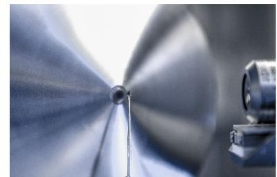
Das Objekt ist auf einem nadelförmigen Probenhalter fixiert und muss nahe vor dem Austrittsfenster positioniert werden.
