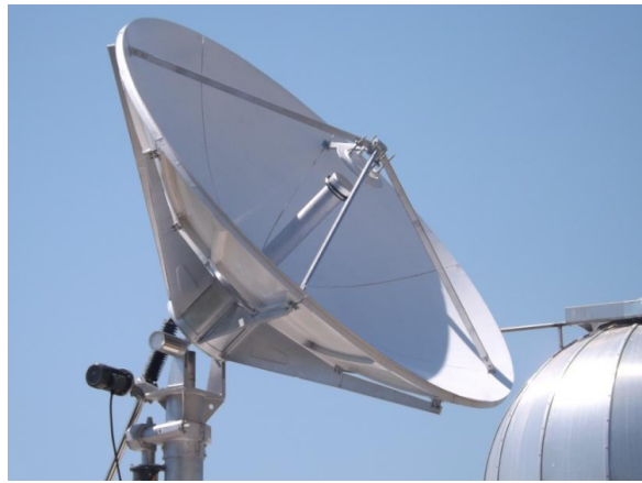
Abbildung 4.1: Das neue 3m Radioteleskop an der Hans Haffner Sternwarte vor der Aluminiumkuppel des optischen Teleskops. Gut zu erkennen sind das Antennenhorn und der Primärfokus im Zentrum des Parabolspiegels
