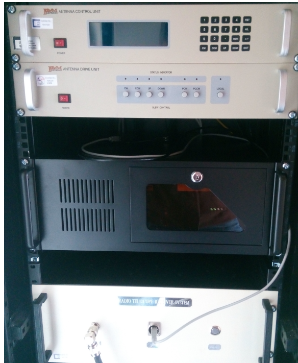
Abbildung 4.2: Der Schaltschrank des neuen Radioteleskops an der Hans-Haffner Sternwarte mit den einzelnen Modulen zur Kommunikation zwischen dem PC, den Motoren und dem Receiver. Von oben nach unten: Antenna Control Unit, Antenna Drive Unit, PC, Receiver System
