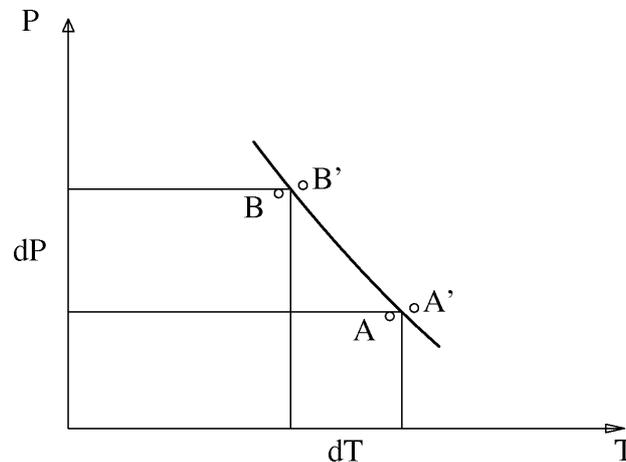
Die Abbildung zeigt schematisch einen Ausschnitt der Koexistenzkurve von flüssigem Wasser und Eis im  $(T, P)$ -Diagramm. Die Punkte  $A, B$  liegen in der festen,  $A', B'$  in der flüssigen Phase;  $dP = P_B - P_A$  und  $dT = T_B - T_A$  können als infinitesimal betrachtet werden.
