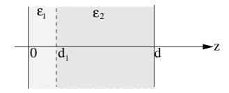
Der Raum zwischen den Platten sei mit zwei Schichten dielektrischen Materials ausgefüllt, wobei die linke Schicht die Dielektrizitätskonstante  $\epsilon_1$  und Dicke  $d_1$  habe. Die andere Schicht habe die Dielektrizitätskonstante  $\epsilon_2$ .
