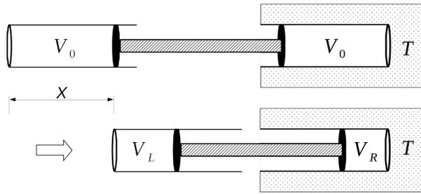
Der linke Zylinder werde nun langsam um die Distanz  $x$  nach rechts geschoben, wodurch die Gase auf beiden Seiten komprimiert werden. Das System ist dabei durch die Größen  $V_L(x)$ ,  $V_R(x)$ ,  $p_L(x)$ ,  $p_R(x)$ ,  $T_L(x)$  und  $T_R(x)$  charakterisiert.
