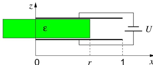
*Hinweis:* Es ist hilfreich, wenn das System als Parallelschaltung zweier Kondensatoren mit bzw. ohne Dielektrikum behandelt wird.
