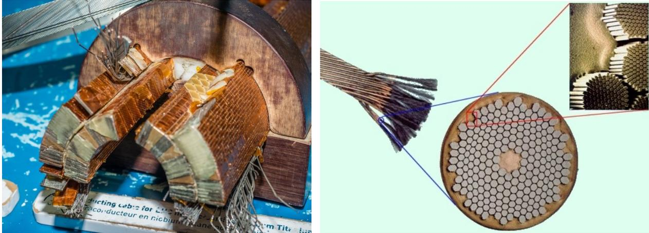
Insgesamt wurden für den Bau der supraleitenden LHC-Spulen etwa 1200 Tonnen NbTi verwendet.
