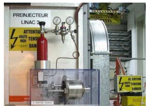
Noch bevor die Protonen in den ersten Vorbeschleuniger LINAC2 gelangen, wird der Protonenstrahl in **Pakete** aufgeteilt.
