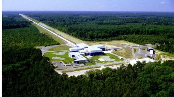
Das LIGO-Interferometer ist empfindlich für Gravitationswellen mit Frequenzen von mehr als  $10\text{ Hz}$  aus höchstenergetischen explosiven Quellen, wie der Verschmelzung stellarer Schwarzer Löcher (vgl. S. 440).
