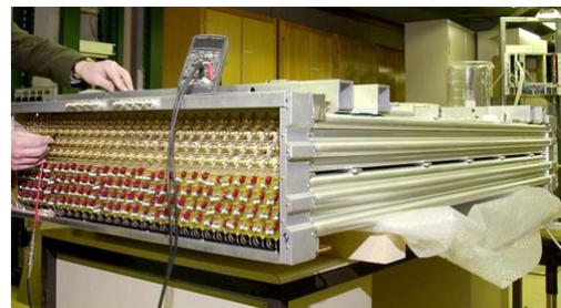
Das Bild zeigt ein Driftrohrenmodul des Myonendetektors des ATLAS-Detektors.
