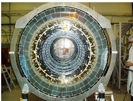
Mit Halbleiterdetektoren kann man die Energie und den Ort eines geladenen Teilchens sehr genau messen. Wird ein ionisierendes Teilchen in mehreren Halbleiterplättchen registriert, die es durchfliegt, so lässt sich die Flugbahn des Teilchens rekonstruieren.
