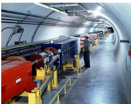
Das **Super Proton Synchrotron (SPS)** ist mit fast 7 km Umfang ein schon recht großer Kreisbeschleuniger. SPS ist der letzte Vorbeschleuniger, den die Protonen vor dem LHC durchlaufen. Hier werden die Protonen auf **450 GeV** bzw. auf eine Geschwindigkeit von **99,9998 % der Lichtgeschwindigkeit** beschleunigt.
