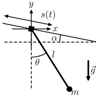
dessen Aufhängung sich unter dem Einfluß einer äußeren Kraft auf einer schiefen Ebene mit Neigungswinkel  $\alpha$  mit einer gegebenen Zeitabhängigkeit  $s(t)$  bewegt.
