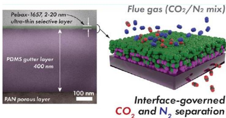
Dünnschichtverbundmembranen ermöglichen eine selektive Abscheidung von CO<sub>2</sub> aus einem Gasgemisch.
