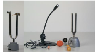
Abb. 1: links die Stimmgabel mit montierter Mine für Versuchsteil (1); links das Mikrofon, die Stimmgabel, die Knete und der Klöppel für Versuchsteil (2)
