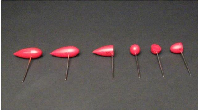
Abb. 5-2: Verschiedene Strömungskörper zur Widerstandsmessung
