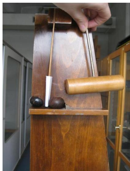
**Abb.17:** Versuchsaufbau zum waagerechten Wurf 3
