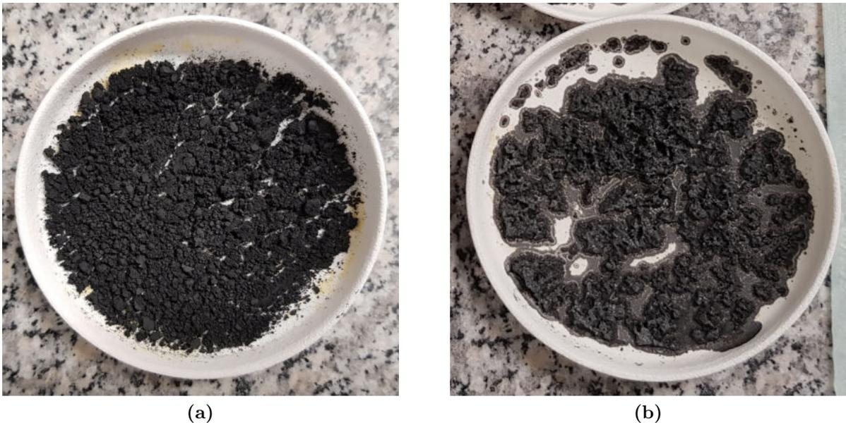
**Abbildung 4.5:** a) YBCO-Pulver nach einem korrekten Sintervorgang. b) YBCO-Pulver nach einem Sintervorgang mit zu hoher Temperatur [Eigene Aufnahmen].
