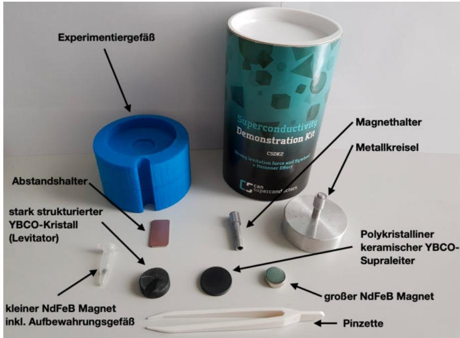
Abbildung 4.16: Inhalt des Demonstration Kits 2 von *Can Superconductors* [Eigene Aufnahme].
