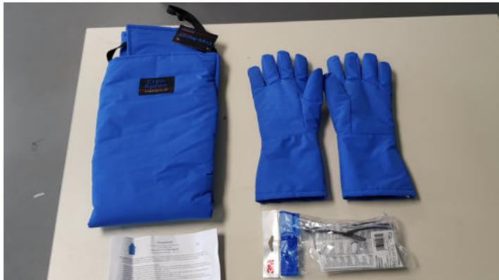
**Abbildung A.3:** Schutzausrüstung für den Umgang mit  $LN_2$  [Eigene Aufnahme].
