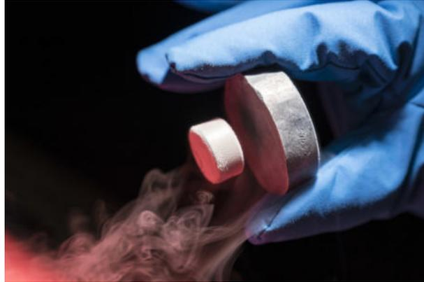
Abbildung 2.21: Flux-Pinning eines Typ-III-Supraleiters. Entnommen aus [75].
