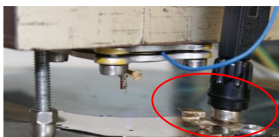
Bild 6: Fertig aufgestelltes STM mit DVD-Master als Probe vor der Annäherung(Nahansicht)
