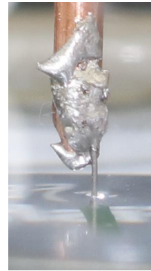
Bild 3: Wolframdraht wird von Laugenoberfläche „halbiert“
