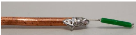
Bild 1: Messspitze bereit zum Ätzen
