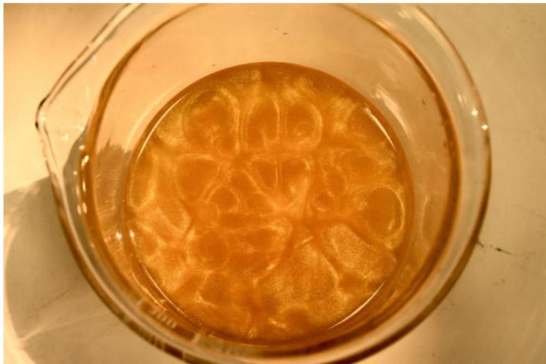
Abb. A.4: Konvektionszellen im Becherglas
