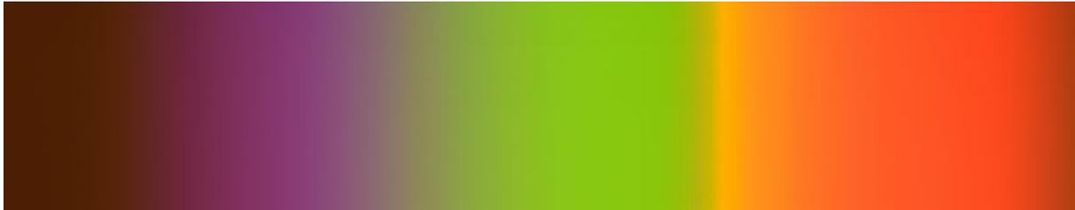
Abb. 4.5: DSLR Sensor Aufnahme des mit einem Gitter aufgespaltenen Graphitspektrums bei ca  $850^{\circ}C$
