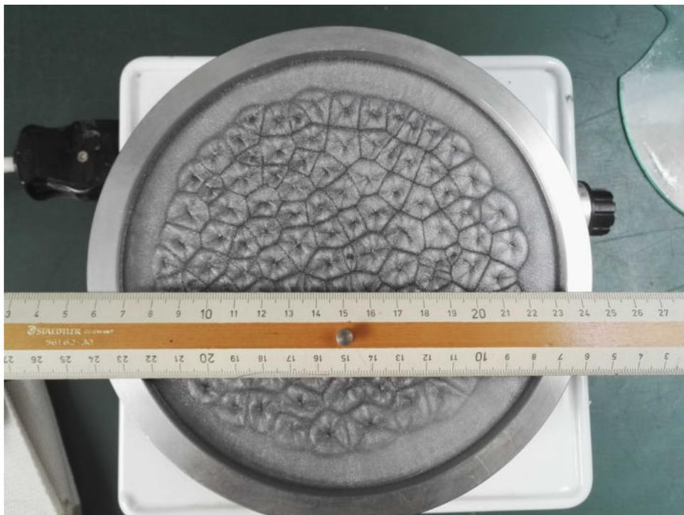
Abb. 2.9: Konvektionszellen in Silikonöl
