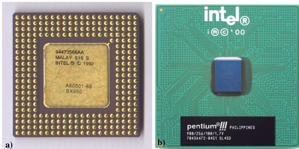
Abb. 69 a) Unterseite Pentium P5 Prozessor mit Metalldeckel zur Abdeckung des Dies [61]; b) Pentium III Prozessor in Flip Chip PGA Gehäuse montiert [62]
