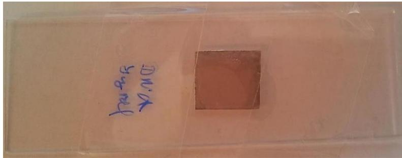
Abb. 74 Zur Abbildung fertiges Glimmerplättchen mit DNA Deposition
