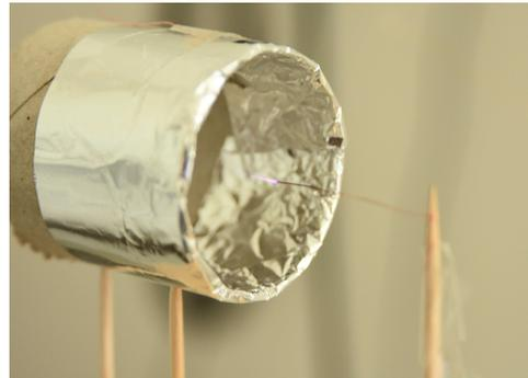
Das Experiment kann problemlos ohne Luftkissenbahn durchgeführt werden, indem der entstehende Luftstrom z.B. an sich bewegenden Stofffetzen oder Fäden sichtbar gemacht wird.
