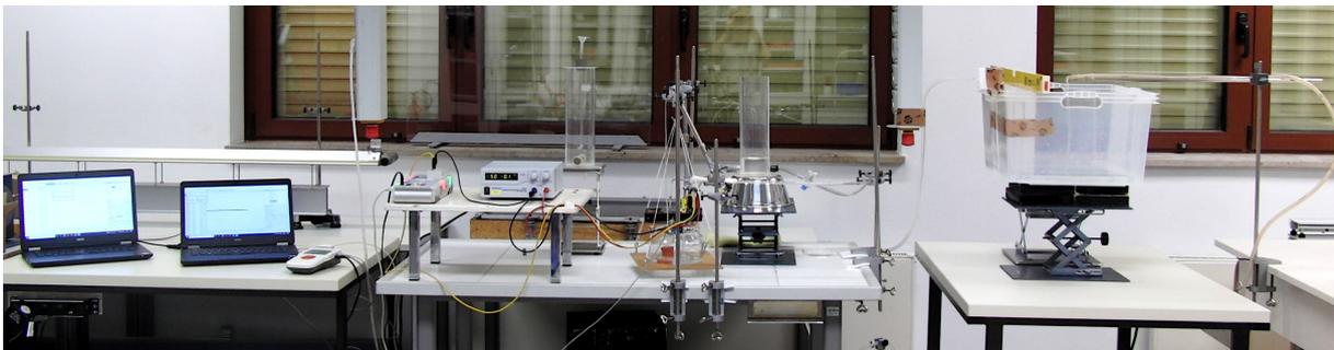
**Abbildung 4.1:** Aufbau des Systems „tropfender Wasserhahn“ mit Mariott'scher Flasche (Mitte), großem Wasserreservoir (rechts) und Messwerterfassung (links)
