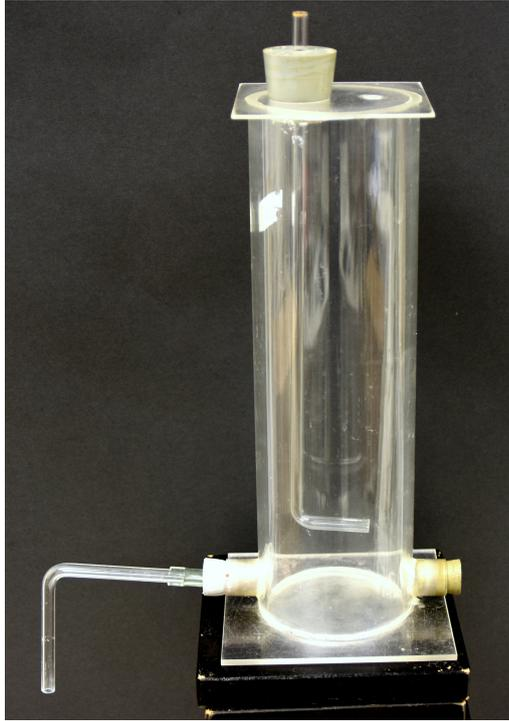
Abbildung A.17: verwendete Mariott'sche Flasche mit den in Kap. 4.1 genannten Eigenschaften; Biegewinkel des inneren l-förmigen Glasröhrchens: etwa  $95^\circ$
