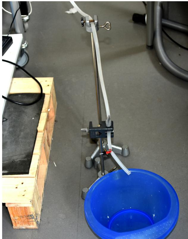
Abbildung A.20: Heruntergeführtes Ende der Entleerungsleitung zur schnellen und störungsarmen Entleerung des Auffangbehältnisses
