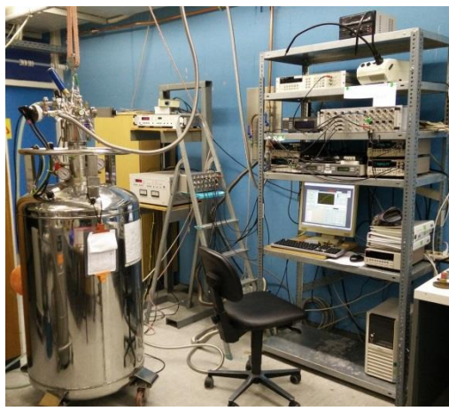
Abbildung 2: He 3 /He 4 Tieftemperaturmessplatz zur (Magneto-) Transportcharakterisierung der InAs/GaSb QWs.
