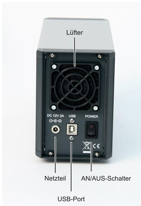
Bild 2: Rückseite Steuereinheit
