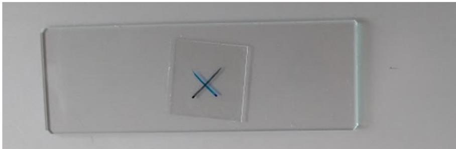
Abbildung 9: Objektträger mit Deckglas, das auf der Ober- und Unterseite mit zwei Folienstiften unterschiedlicher Farbe markiert wurde. Dies dient zur Dickenmessung des Deckglases.
