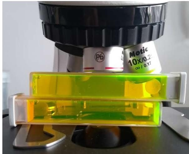
Abbildung 14: Die Küvetten mit der Fluoreszinlösung werden so auf den Objektstisch gelegt, dass die klare Seite von vorne sichtbar ist. Um den Öffnungswinkel der Objektive zu untersuchen, müssen diese so nah wie möglich an die Küvette gebracht werden.
