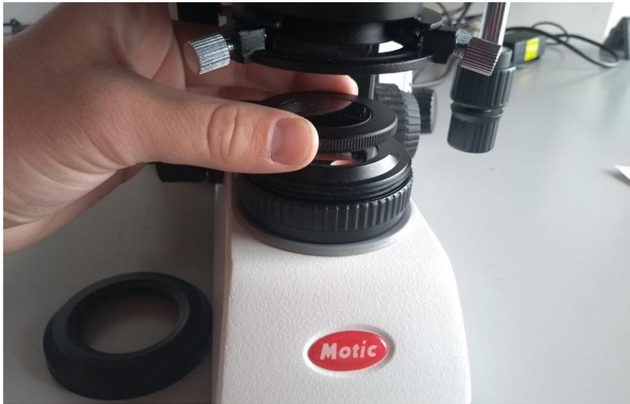
Abbildung 18: Aufrüstung zum Polarisationsmikroskop. Die abgeschraubte Kollektorabdeckung wird durch einen drehbaren Polarisationsfilter ersetzt. Der andere Filter ist bereits oberhalb der Tubuslinse eingebaut.
