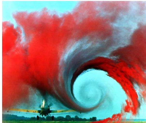
*Wirbelschlepe eines Flugzeugs beim Start. Foto: NASA*
